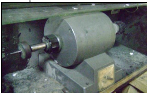
Рисунок 12. Общий вид установки для полировки лопаток компрессора
